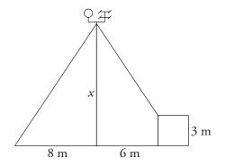
4 Para calcular la altura de una torre, María clava en el suelo un listón de tres metros de altura y, después, retrocede hasta que coinciden en la visual los extremos del listón y de la torre. A continuación, toma las medidas que ves en la ilustración. Con esos datos, resuelve el problema.
