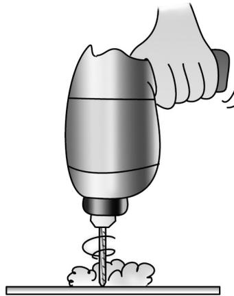
En este proceso se observa que parte de la energía cinética de rotación de la taladradora se transforma finalmente en calor.
